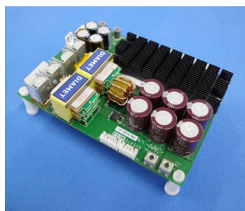
写真・図：合金系圧粉コアを使用した試作基板と当社提案方式ブロック図
